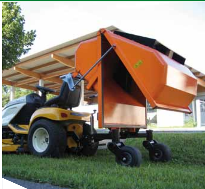
Manuální vyprazdňování na zem pomocí tlakových píštěl
