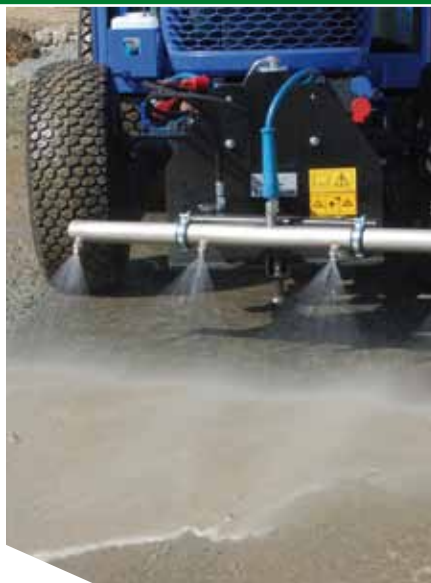
Více vody, menší tlak: mycí rám odstraní volné nečistoty
